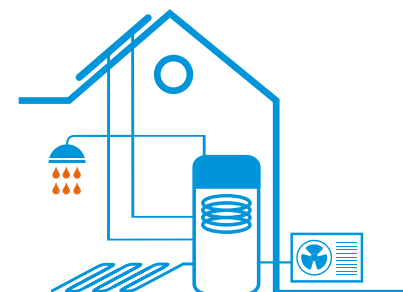
Vloermodel met geïntegreerde ECH 2 O thermische energieopslagtank Maximale duurzame energie en optimaal comfort bij het produceren van warm tapwater
